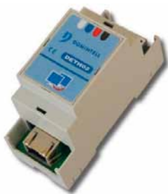
Ethernet modul DETH02 používaný pro vzdálenou správu a přístup
